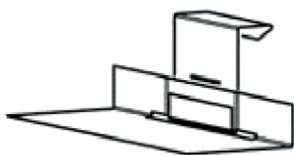
**Μεταβλητοί σύνδεσμοι:** χρησιμοποιούνται για την παραλαβή των συστολοδιαστολών λόγω θερμοκρασιακής μεταβολής όπως φαίνεται παρακάτω :
